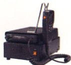
FP-33 指令局用直流安定化電源 卓上型として使用する場合の 電源装置。 大型スピーカー内蔵
