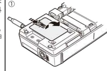
② バッテリーパックの突起部を上にしてケース内に入れ、軽く下方向に押しこみながら奥に押して止めます。その後電池カバーを元に戻します。
