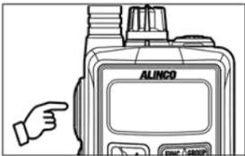
※一定の強さ以上の信号を受信しているときはキャリアアセスが働き、「ププ」という警告音が鳴り送信できません。受信信号が無くなり、Sメーターが消灯すると送信できます。ピープ音量(操作音)をOFFに設定しているときは、警告音は鳴りません。
