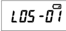
※「電源が入らない」「オンオフを繰り返す」「ディスプレイ表示が消える」「ハウリング」などの症状が出た場合も電池の消耗が考えられるため、新しい電池と交換してください。電池選択(セットモード)設定が適正でないとき正しいタイミングで電池交換時期を表示しません。
