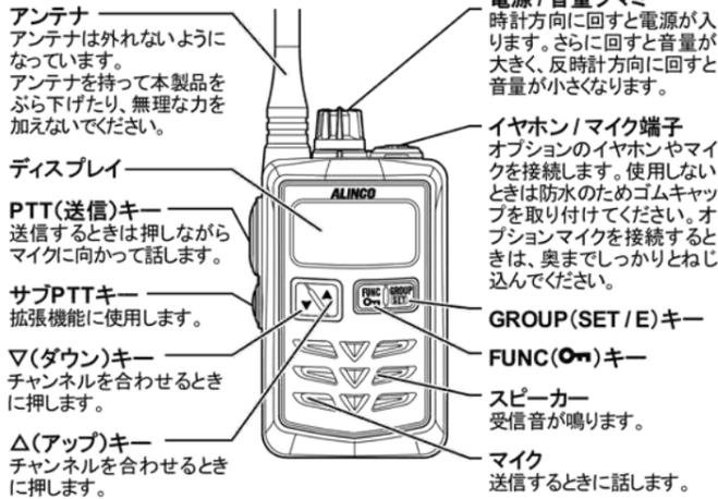
※マイク穴にシール類を貼り付けしないでください。送信する際の音声を拾わなくなります。イヤホンマイク製品をご使用の際は、ケーブルに無理な力が加わって断線しないよう、取り扱いにご注意ください。
