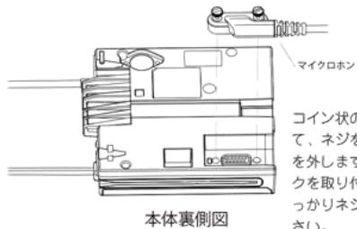
コイン状のものを使用して、ネジを緩めてプラグを外します。新しいマイクを取り付けるときはしっかりリネジ止めしてください。
