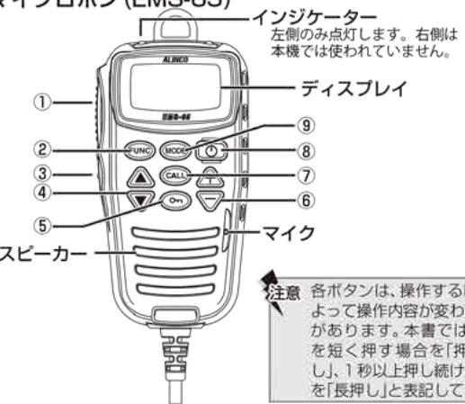
注意 各ボタンは、操作する時間によって操作内容が変わることがあります。本書では、キーを短く押す場合を「押す、押し」、1秒以上押し続ける場合を「長押し」と表記しています。
