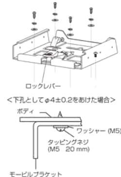
モービルブラケットのガイド部分に、本機側面にある溝を合わせ、カチッと鳴るまでスライドさせて固定します。
