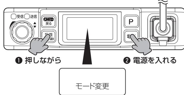
3. 「モード変更」と表示されて「ピッ」と鳴ったら、すべてのスイッチから手をはなして、1秒以内に【機能/□○】スイッチを短く押します。
