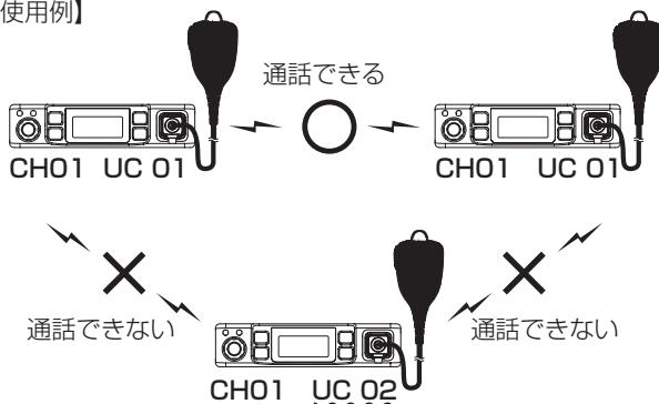
※説明のため、送信ユーザーコードと受信ユーザーコードを同じ設定にしたときの例を使用しています。
