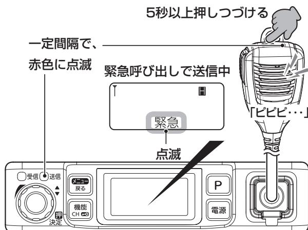
3. 「緊急」表示が点滅した状態で、相手局から応答があるのを待ちます。
