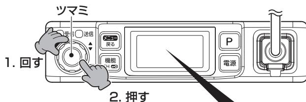
1. ツマミを回して、設定するユーザー コードを選択します。
