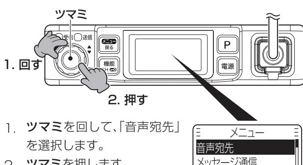
1. ツマミを回して、「音声宛先」を選択します。
