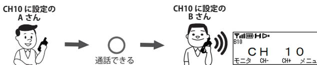
通話する相手局と同じチャンネルに合わせます。相手局の電波を受信すると、LED が緑色に点灯し、スピーカーから受信音が聞こえます。
