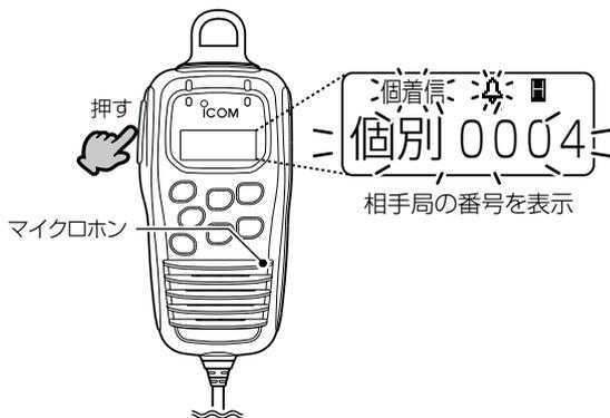
[PTT]スイッチから手をはなしたあと、[全/基]スイッチを押すと、点滅が停止して[▲]/[▼]スイッチを操作できます。
