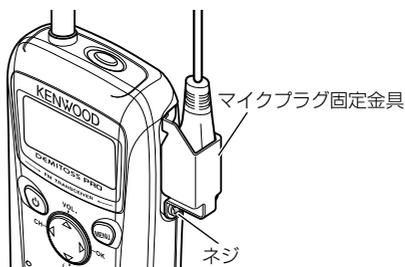
ネジをプラスドライバー（#1）で右方向に回し確実に締め付けてください。
