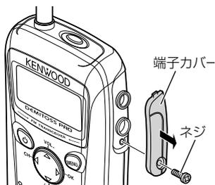
プラスドライバー（#1）でネジを左方向に回して取り外し、端子カバーを外します。
