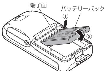
**!** 端子面の反対側を先に入れてからバッテリーパックを取り付けると本体の端子金具が変形することがあります。
