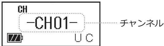
※チャンネルを変えるときは、ロータリースイッチをまわして、相手と同じチャンネルに合わせます。
