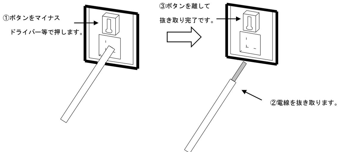
電線接続手順 (抜き取るとき)
