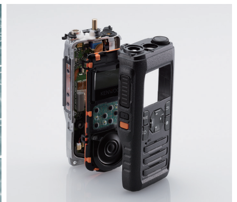
防塵/防水/衝撃/歪に強い2重構造
