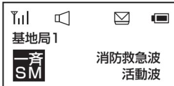
SM 自動表示 (☞ P.26) をオンに設定すると、受信したショートメッセージを自動的にディスプレイに表示します。受信したメッセージがディスプレイに納まらなかった場合は、ディスプレイ右側に表示の続きがあることを示す「▼」マークを表示します。続きのメッセージを表示するには、「▼」キーを押して、画面をスクロールします。
