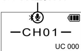
2. 音声自動送信(VOX)機能をオフにするには、もう一度側面の P1 キーを短く押します。
