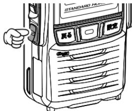
3. “Bluetooth を ON にしますか？”の画面が表示されますので、左ページの“Bluetooth® ヘッドセットを使う場合”的操作を行って、新たに接続したいヘッドセットと接続します。
