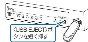
11 [POWER]ランプが ● 緑点灯に切り替わったことを確認してから、[USB]ランプが消灯するまで、<USB EJECT>ボタンを押しつづけます。
