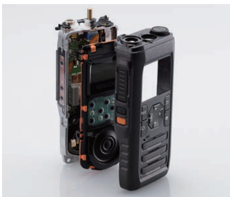
防塵/防水/衝撃/歪に強い2重構造
