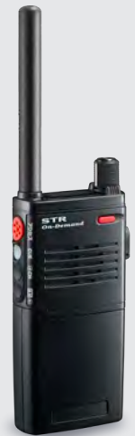
(SBT-18 乾電池ケース装着)
