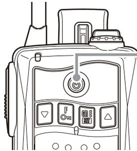
[電源] キーを長押しするとランプが青色に点灯し、チャンネルとグループを音声でお知らせして電源が入ります。再度長押しすると電源が切れます。
