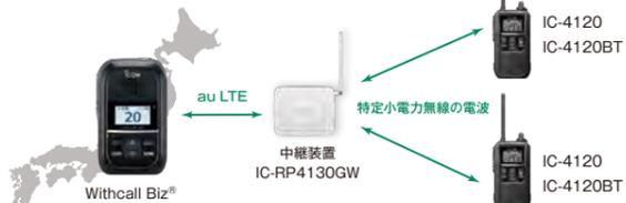
Withcall Biz<sup>®</sup>は、auのLTE回線を使って日本全国<sup>※2</sup>で通話でき、さらに中継装置経由で特定小電力トランシーバーとの連携も可能な新ジャンルのトランシーバーです。
